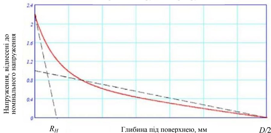
Рис. 3.1-2. ККН при крутінні в галтелі шатунної шийки залежно від глибини. Відповідний ККН для галтелі рамової шийки може бути визначений шляхом заміни R_H на R_G і D на D_G
