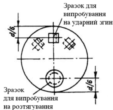
Рис. 7.2.2.2.3.3. Розташування зразків. Пруток, поковка, виливок, злиток.
