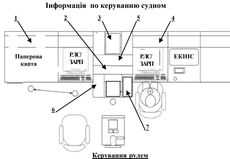
Рис. 3.3.4 Зразок розташування основного обладнання на центральному пульті поста, який забезпечує виконання функцій маневрування.
