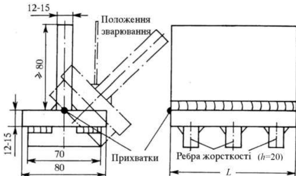
Рис. 4.2.4.1 Таврова проба для оцінки стійкості зварних з'єднань до утворення гарячих тріщин (розміри наведені в мм)
