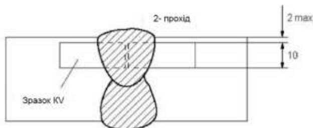
Рис. 4.4.3.2.3 Схема вирізки зразків на ударний згин для проби стикового з'єднання, виконаного за двопрохідною технологією зварювання (позначення зразка для випробування відповідає табл. 4.4.1.4, всі розміри в мм)
