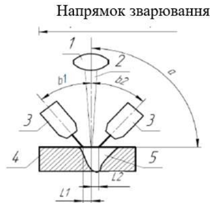
Рис. 2.16.1.1-5 Схема ГЛДЗ, метод «Гібрид Тандем» стикового зварного з'єднання в нижньому положенні (РА):
