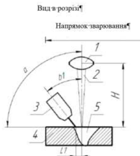
Рис. 2.16.1.1-1 Схема ГЛДЗ, метод «Гібрид» стикового зварного з'єднання в нижньому положенні (РА):
