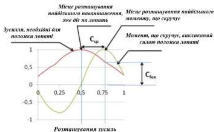
Рис. 2.9.2.5.4.2 Сила поломки лопаті і відповідний момент, що скручує, при впливі сили у різних точках по лінії циліндричного перерізу лопаті на відносному радіусі 0,8R
