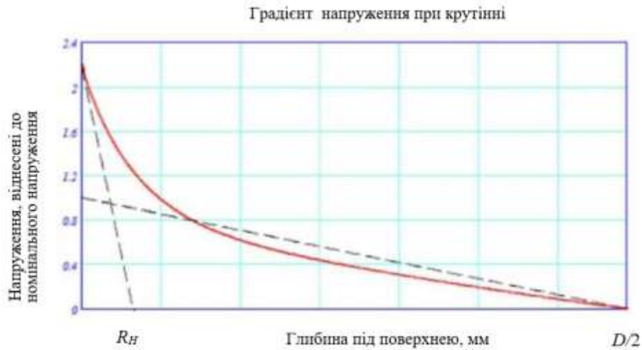
Рис. 3.1-2. ККН при крутінні в галтелі шатунної шийки залежно від глибини. Відповідний ККН для галтелі рамової шийки може бути визначений шляхом заміни R_H на R_G і D на D_G
