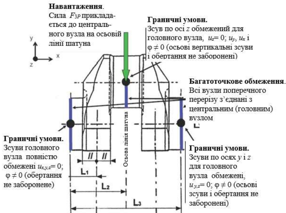
Рис. 3.3. Граничні умови і умови навантаження для випадку трьохточкового вигину при рядному двигуні
