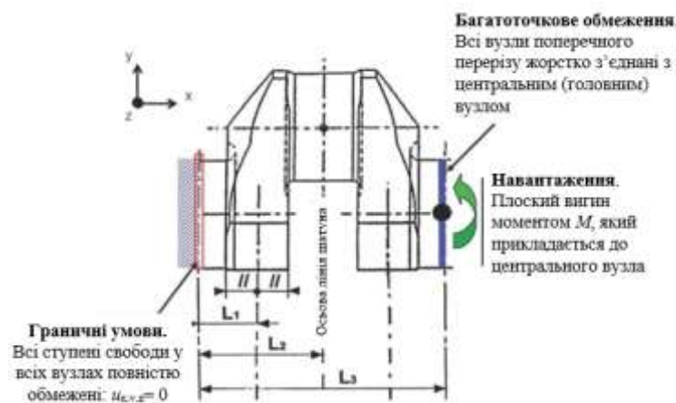
Рис. 3.2. Граничні умови і умови навантаження для випадку навантаження чистим вигином
