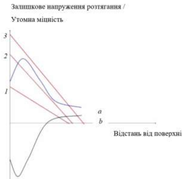
Рис. 6.1. Робочі і залишкові напруження під поверхнею після карбування.
